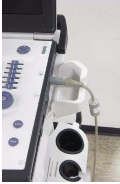
Şekil 4-1: EKG konnektörü için koruyucu destek
