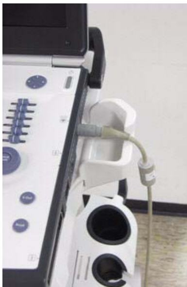
Slika 4-1: Zaštitna potpora za poveznik EKG-a
