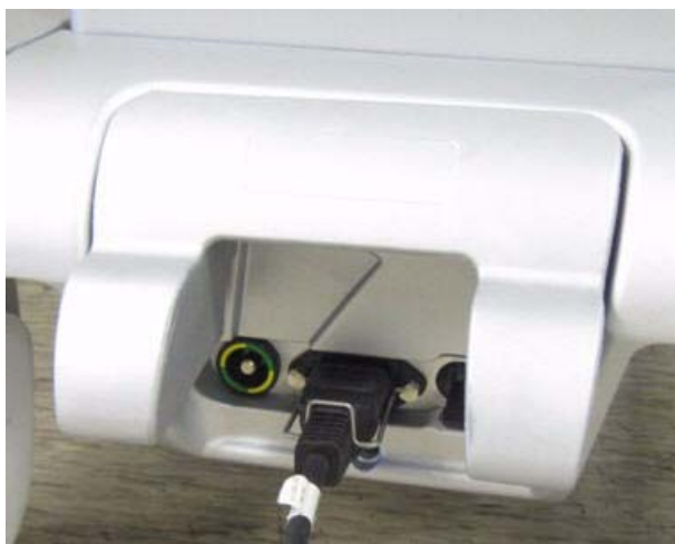
4-2. ábra: Faltól védő ütköző a tápkábelhez
