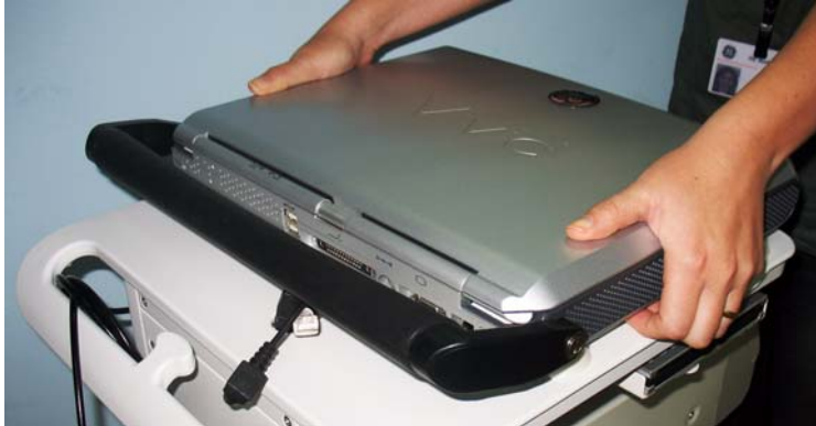
Slika 2-3: Postavljanje na zadnje klizne vođice
