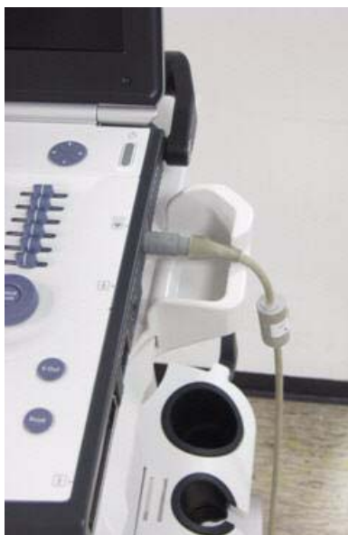
Фигура 4-1: Защитна опора за ЕКГ конектор
