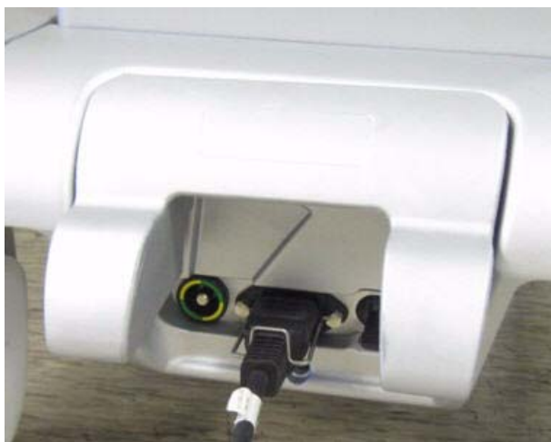
Obr. 4-2: Ochrana přívodní šňůry před nárazy do zdi
