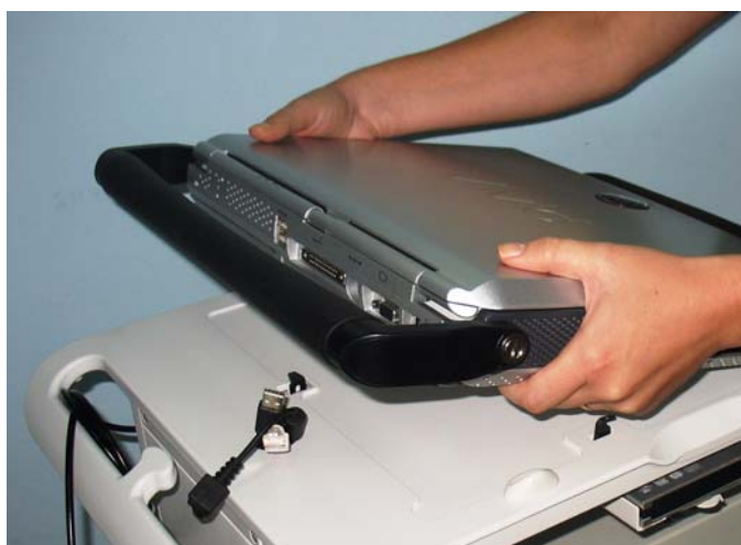
Slika 2-2: Postavljanje na prednje klizne vodilice
